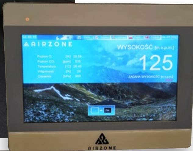
PONIŻEJ: Urządzenie do ustalania wysokości w sali treningowej COS OPO Cetniewo
